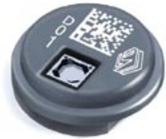
Kapasitiivisessa paineanturissa paine taiputtaa piikalvoa ja muuttaa kapasitanssia. Paineanturikomponentissa alle millimetrin kokoinen piikalvo paljastetaan ulkomaailmaan mutta muut osat ovat muovikotelon suojassa.
