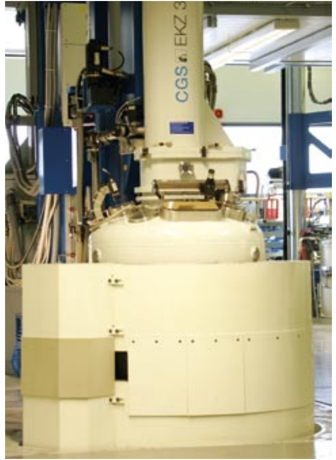
Kuva 3. Hyvin yksinkertaistettu kuva CZ-uunin kuumavyöhykkeen grafiittiosista ja kiteenkasvatusuunin kasvatuskammio magneetteineen. Figure 3. Simplified picture of a CZ furnace hot zone graphite parts and a CZ furnace growth chamber with a magnet.
