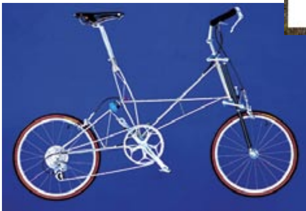
Kuva 2. Kevyt ja nopea Moultonin pyörä on tehty erikoislujasta ruostumattomasta teräksestä. Fig. 2. A light and fast Moulton bicycle made of high strength stainless steel.
