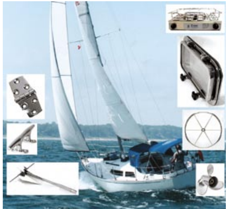
Kuva 1. Veneissä turvallisuuden kannalta tärkeät osat ovat ruostumatonta terästä. Tällaisia osia ovat mm. kaiteet, portaat ja vaijerit, ankkuri, potkuri, ruori, kiinnikkeet jne. Fig 1. All major safety critical details are made of stainless steel in boats.
