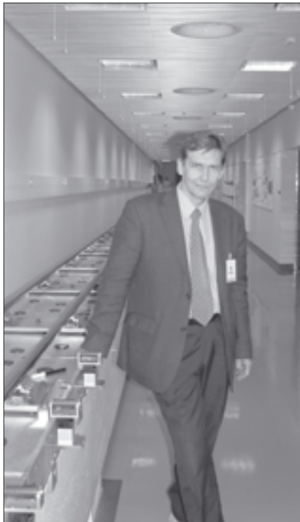
Laboratoriokerroksen käytävälle rakennettu mittarata, jonka avulla voidaan kalibroida erilaisia pituusmittoja aina 30 metrin saakka. Kuvassa Heikki Isotalo.
