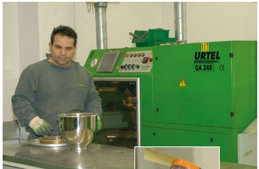
Oikean segmenttimassan sekoittaminen on tarkkaa puuhaa. Kuvassa operaattori Ahmad Jahvadi punnitsemassa raaka-aineita.
