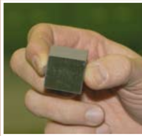
Levannon ydinosoaminen on segmentin valmistuksessa. Valmis segmentti juotetaan kiinni työkalun terään.
