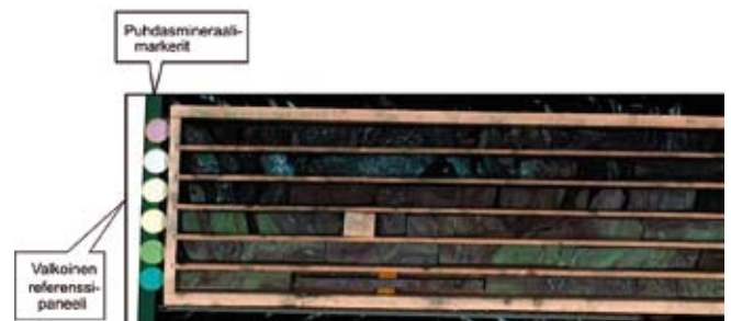
Kuva 1. Kolmen kanavan väärävärikuva Petäjälän kultamalmiaiheen kairansydämistä (Laatikko 17). Kohteeseen on sijoitettu valkoinen referenssiheijastaja tuloksen kalibrointia varten ja puhdasmineraalijauheita (markerit, ylhäältä lukien: muskoviitti, kalsiitti, dolomiitti, kloriitti ja biotiitti) tulkintatuloksen validointia varten.
