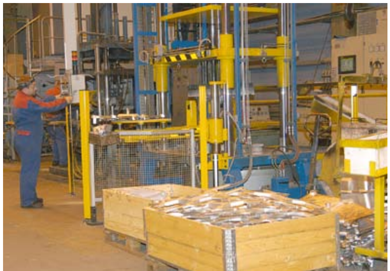
Kokillivalukone. Kokillivalujen osuus Alteamsin liikevaihdosta on noin kymmenen prosenttia.
