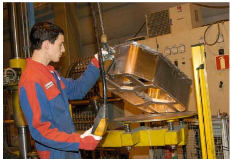
Mikko Kiltinen nostaa valetun kappaleen matalapainevalukoneesta. Tämän kappaleen valamiseen kuluu noin 6 minuuttia.
