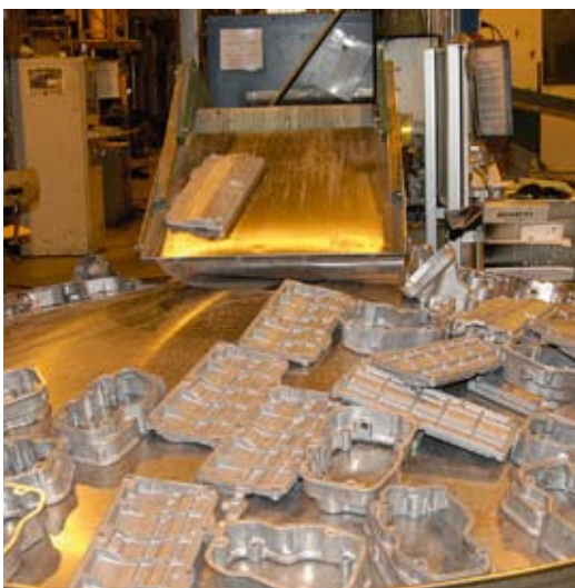
Valetut kappaleet odottavat painevalulinjan päässä lajittelevaa pakkaukseen varten.
