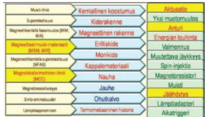
Kuva 3. Ferromagneettisten muistimateriaalien multifunktionaalisuus [3]. Figure 3. Multifunctional properties of ferromagnetic shape memory alloys.
