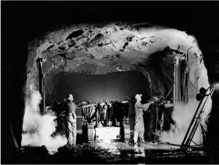
Kuva 4. Kaksi Tampellan hydraulista HP2900-puo- mia pitkäreikä- porauksessa telaketjualus- talla v. 1965 Outokummun kaivoksella.
