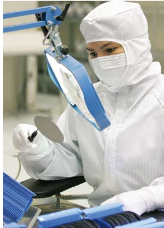
Okmetic'in prosessoija tutkii piikiekkoa yhtiön Vantaan tehtaassa tuotannollisessa puhdistilassa. Kuva Okmetic Oyj
