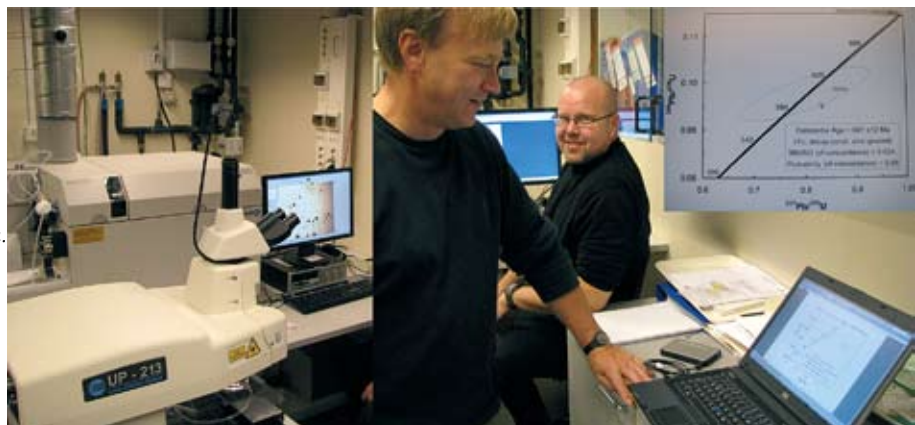
▶ Kuva 3. Geologian ja maantieteen laitoksen geokemian laboratorion yksi keskeinen uusi tutkimusväline on laserablaatiomassaspektrometri, joka koostuu UV-laserista, kvadru-polimagneetista ja induktiivisesti kytketystä plasmalähteestä. Laitteella voidaan määrittää nopeasti ja tarkasti mm. mineraaliaineksessa olevien hivenalkuaineiden pitoisuus ja sitä voidaan käyttää myös uraani-lyijy-äänmäärityksiin. Vasemmalla laserlaite ja plasma- ja massaspektrometriyksikkö. Oikealla vasemmalta professori Tom Andersen (Oslo yliopisto) ja FT Juhani Virkanen tarkastelemassa laitteella suoritettua ensimmäistä zirkonikiteen iänmääritystä, jonka U-Pb-konkordiadiagrammi nähdään kuvan oikeassa yläkulmassa (Kuvat Tapani Rämö)
