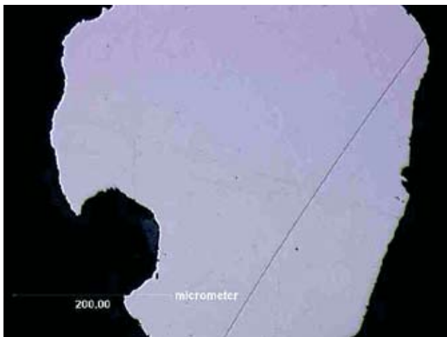
Kuva 3. Miessiitti-rae Miessijoelta. Tasopolarisoitu valo, näyte Miessi III, mittajanan pituus 200 µm. Kuva Kari Kojonen
