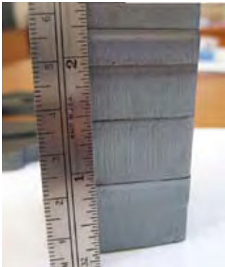
Kuva 4. Kuitulaserilla leikattuja hiiliteräskappaleita, paksuus 5-20 mm. Lähde: IPG Photonics, 2010.
