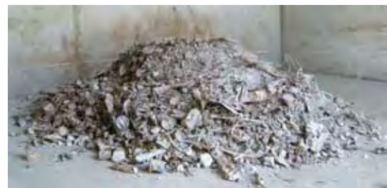
Käsittelemätöntä jätteenpolton pohjakuonaa.
