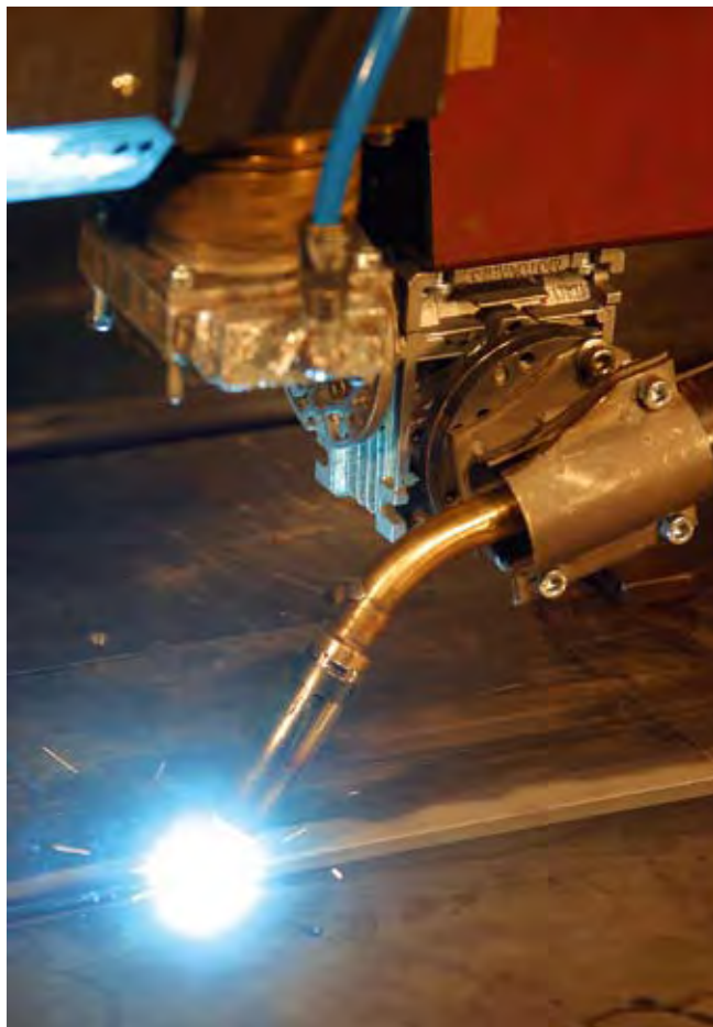
Kuva 2. Päittäisliitoksen hybridihitsaus (kuva: Erkki Makkonen). Fig 2. Hybrid welding of butt joint.
