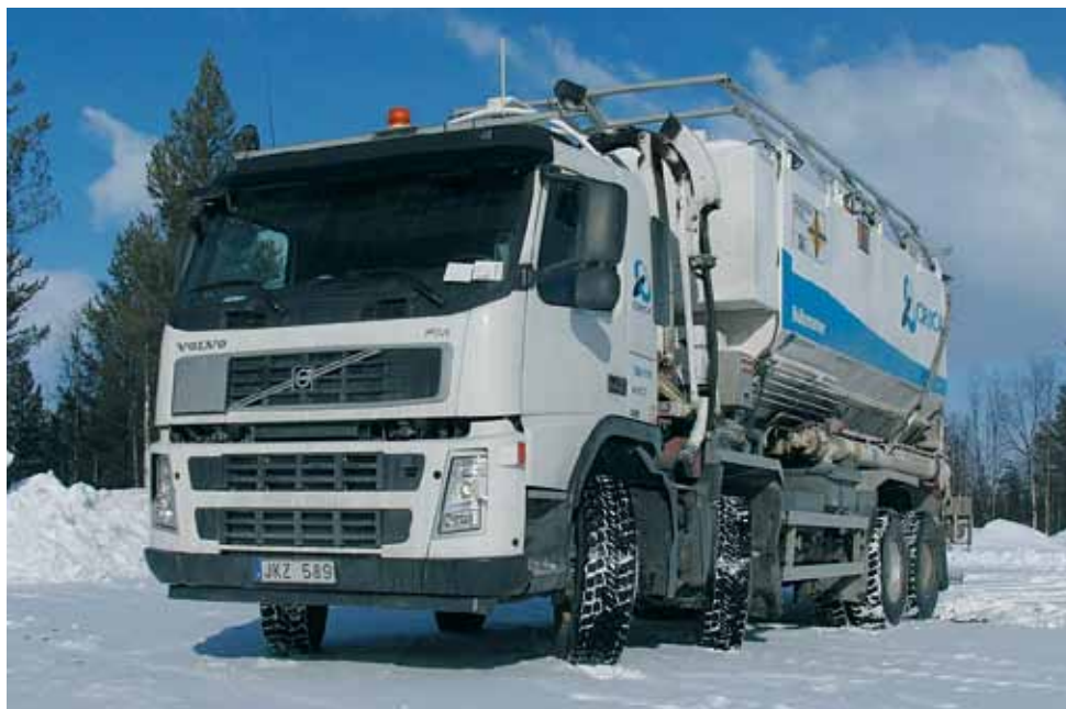
Kuvan raskaan sarjan panostusajoneuvoa käytetään suurilla avolouhoksilla. Kuva Panu Kaukinen
