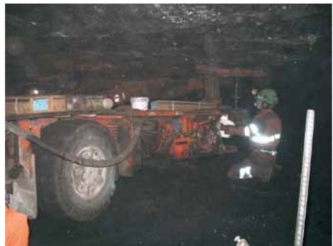
Kallion tuentaa pulttauskoneella Store Norsken hiilikaivoksella. Tunnelin korkeus puolisentimeträ. Kuva Henricki Rutanen
