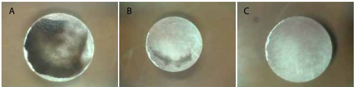
Saostuman liukeneminen keraamisen suodinväliaineen pinnalta, kun sitä regeneroidaan. Kuva Riina Salmimies
