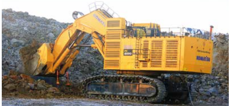
Sähkökäyttöinen Komatsu PX8000 E pistokauhakone.
