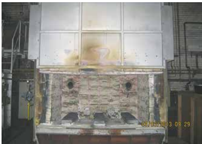
Kuva 1. Kokeissa käytetty lämpökäsittelyuuni. Figure 1. The heat treatment furnace used in experiments.
