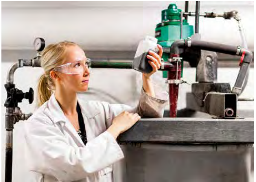
Riina Salmimies ja hydroykloni, jolla erotetaan erikokoisia partikkelifraktioita. Kuva Teemu Leinonen
