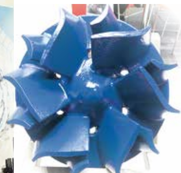
HVF-pumpun ilma-aukot estävät ilman kerääntymisen juoksupyörän silmään.
