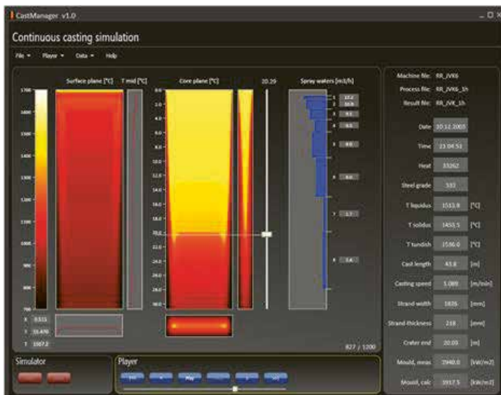
Jatkuvavalusimulaattorin avulla voidaan nähdä jäähdyttämisen etenemisen valunauhan sisällä (Aalto-yliopisto).
