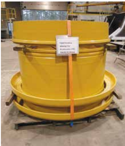
Uudenveroinen kunnostettu vannepaketti lähdössä asiakkaalle.
