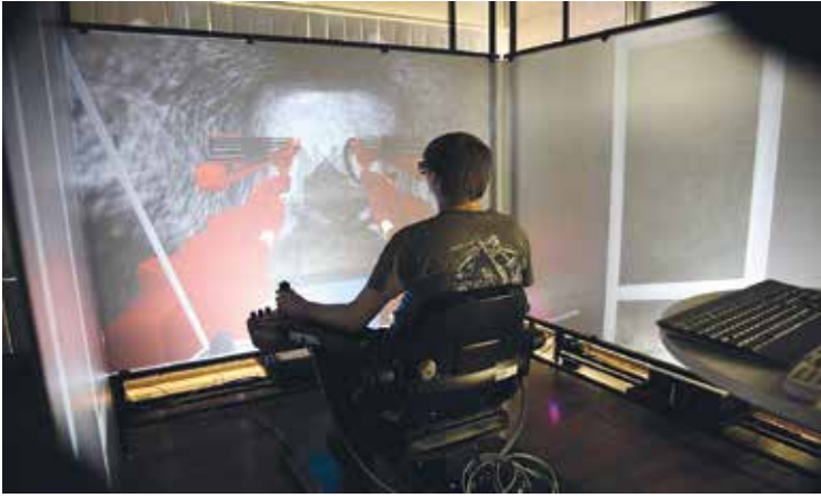
↕ Uuden DD422i-poralaitteen tuotekehitykseen rakennettu luola. Käyttäjä istuu ohjaimilla varustetussa todellisen poralaitteen ohjaamon istuimessa.
