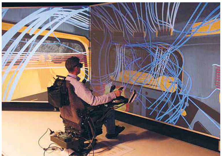
Ohjaamon ilmastoinnin simuloinnissa tutkittiin suuttimien sijainnin vaikutusta mm. vetoisuuteen, ikkunoiden huurtumiseen ja kevyen pölyn kulkeutumiseen.
