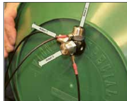
Kuva 1. Kiihtyvyyssantureiden sijoittelu ja mittausakselit vaskauksessa.
