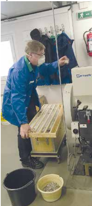
Kai Tiihonen murskaa kairasydäntäytteitä.
