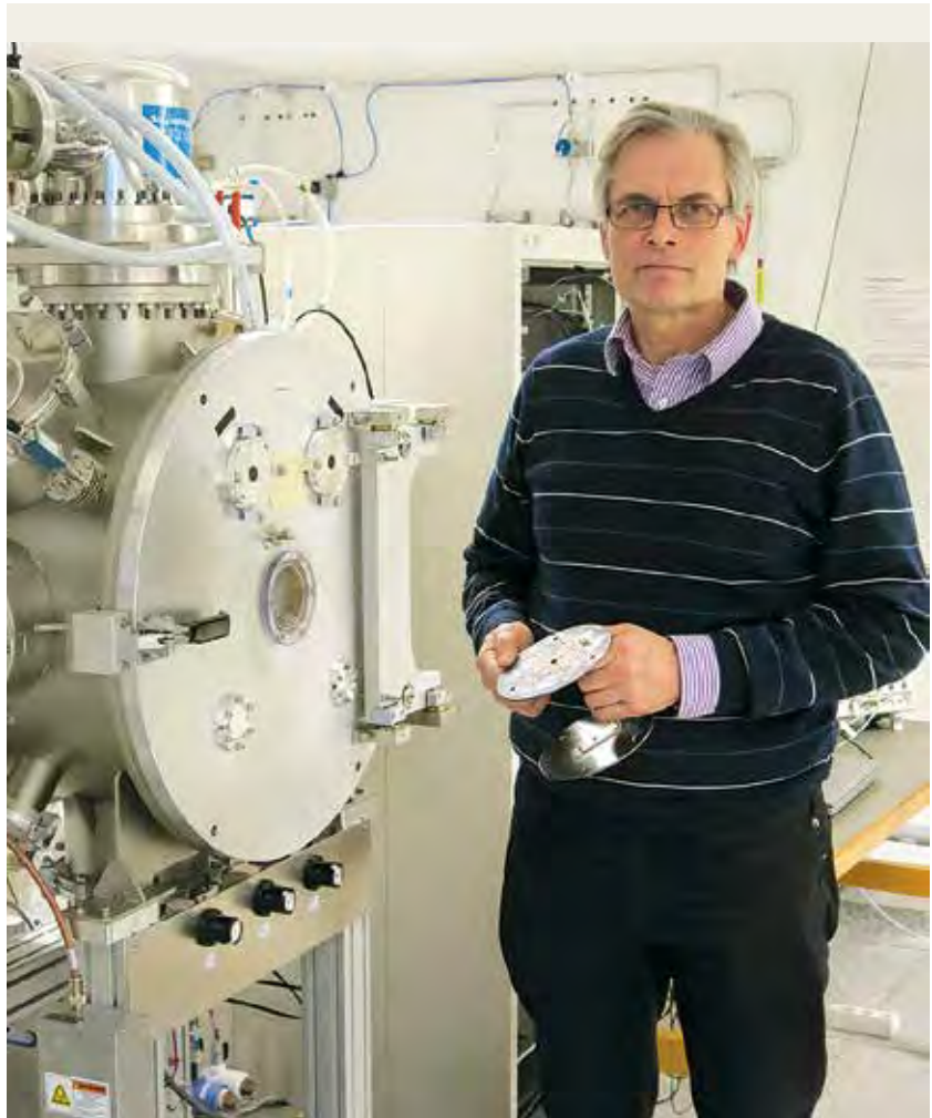
Jari Koskisen vieressä ohutkalvojen kasvattamiseen kehitetty tyhjiöpinnoituslaite, jossa on viisi erillistä plasmalähdettä.
