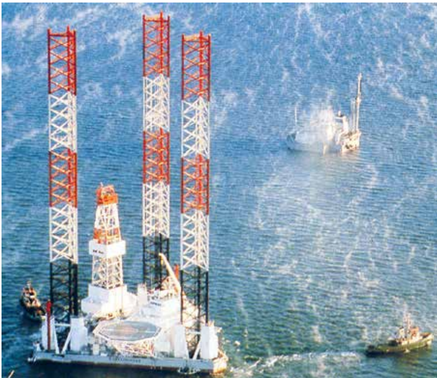
Rauma-Repolan Mäntyluodon tehtaiden johtajana toimineen TkL Matti Mattilan mukaan jack-up-tyyppiset öljynsintälaatat olivat valmiina täyden mittakaavan tuotteita.
