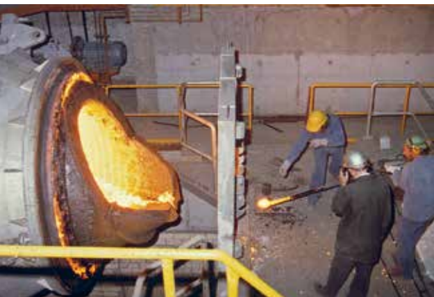
Näytteenotto ja lämpötilan mittaus tyhjäkonverterista.
