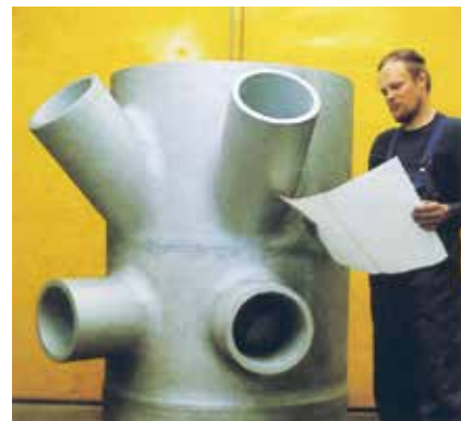
Jack-up-tyyppisten öljynetsintälautojen jalkojen rakentamista varten valetut ristikkorakenteen solmukohdat eli nodit olivat jyhkeitä teräsvaluja.
