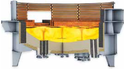
Kuva 2. Pohjahuuhtelun periaatekuva. Kuvassa oikealla uunin poikkileikkaus [2]. Pohjahuuhtelulla on ollut selvä positiivinen vaikutus kuohumiseen, sulan lämpötilan ja koostumuksen tasaisuuteen sekä varsinkin uunin vuorausten kestoan.
