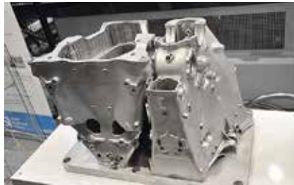
Vossi Group Oy:n osastolla olivat nähtävinä 3D-tulostusta käyttäen yhdessä työvaiheessa valmistetut identtiset kilpa-auton alumiiniset vaihteistokotelot.
