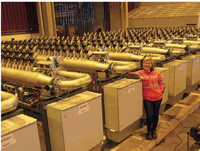
Iina Vaajamo tarkastamassa lähetettäviä Sentinel-vesitukkeja Turulan konepajalla.
