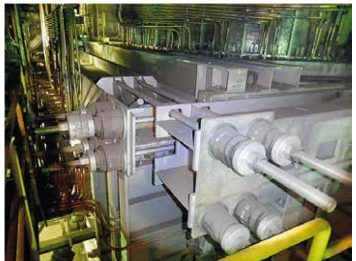
Liekkiuunin aluunin yläosan joustava rakenne asennettuna ja ylöslämmitettyinä.
