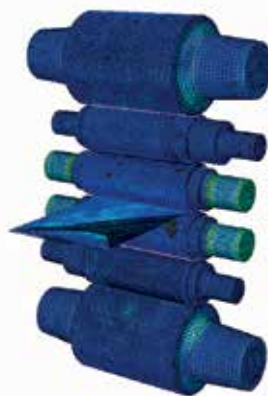
Kuva 2. Steckel-valssaimen 3D FE-mallin ulkoinen ekvivalentti von Mises-jännitysja-kauma 1. piston aikana.
