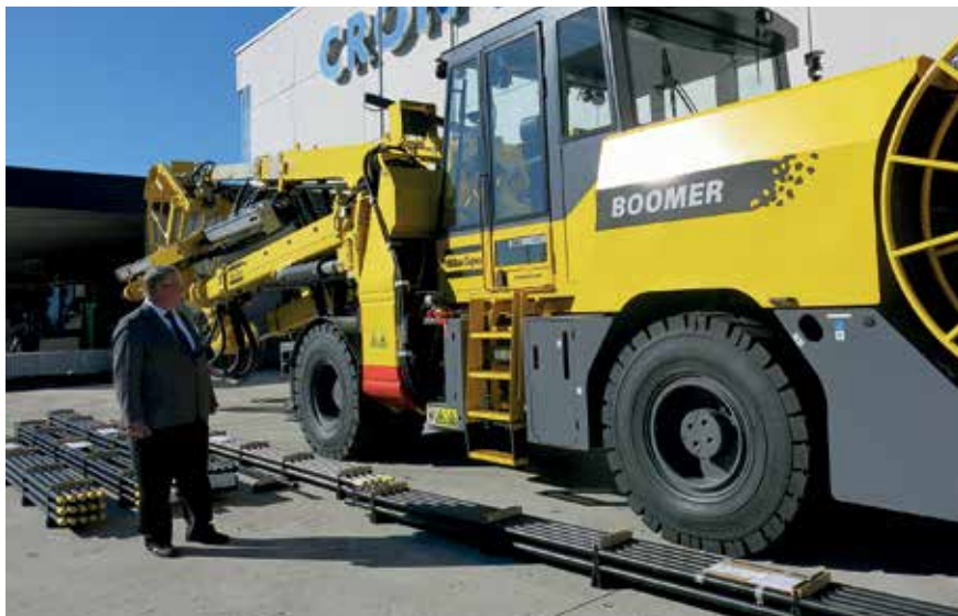
Uusi 40 kW:n kalliorakone Cop 4038 on hyvä esimerkki onnistuneesta tuotekehityksestä. Katkonporauksessa on saavutettu 4,5- 5,5 metrin tunkeutumisoikeuksia minuutissa 48 mm:n terällä Espoolaisessa työkohteessa.
