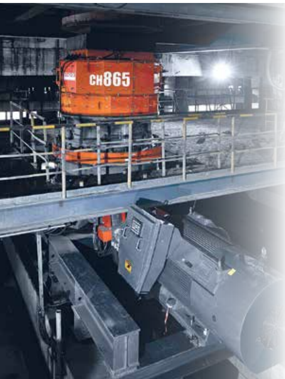
Sandvik CH865 -kaivosmurskain edustaa uusinta hienonustekniikkaa
