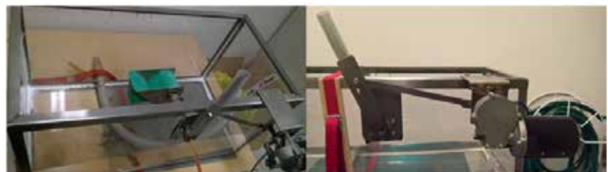
Kuva 2: Konevaskoolin testilaite ylhäältä kuvattuna (vas.). Erottelijan edestakainen liike saa voimansa henkilöauton tuulilasinyyhkijän sähkömoottorista (oik.).
