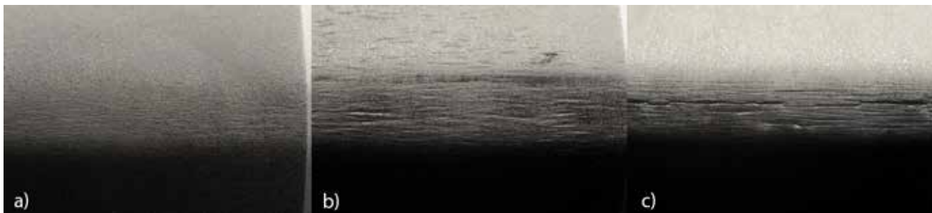
Kuva 5. a) Hyväksytty särmäys, b) ja c) liian pienellä taivutussäteellä särmättyyn teräkseen syntyneitä vaurioita
