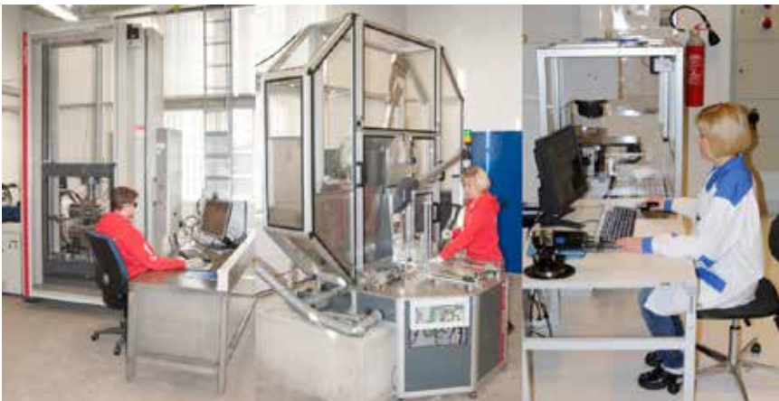
Kuva 10. ASM TKI-ryhmän laboratorio Kemissä, vetokoe-, iskukoe- ja kovuusmittauslaitteistot.
