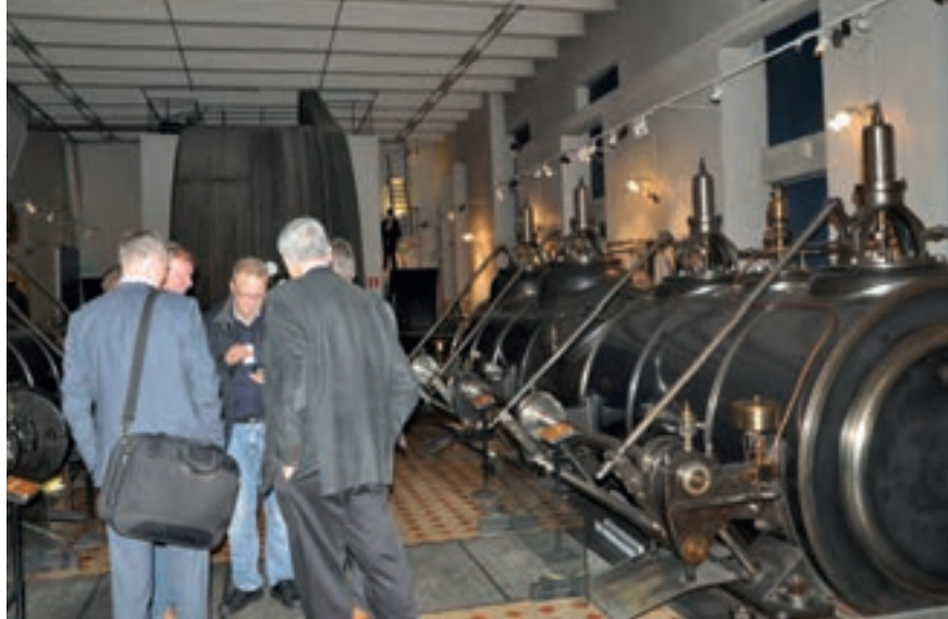
Esitysten päätteeksi tutustuttiin Finlaysonin tehtaiden käyttövoimana toimineisiin höyrykoneisiin. Takana massiivinen vauhtipyörä, jolta voima johdettiin tehtaan eri yksiköihin hihnavälitysten avulla
