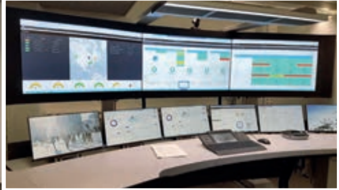
Kuva 3: ABB:n Pitäjänmäen etäpalvelukeskuksesta voidaan monitoroida ja tarvittaessa jopa ohjata ABB Ability™ -järjestelmään kytkettyjä laitoksia ja laitteita. Palvelu on asiakkaiden tukena tarvittaessa 24/7/365 lyhyelläkin vasteajalla. Kuva: Jani Jansson.
