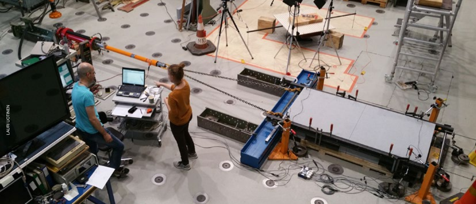
Kuva 1. KARMO-tutkimushankkeen rakopinnan leikkauskoe ASPERT 2000 mm x 950 mm kokoiselle Kurun graniittilaattaparille, joiden välissä on mekaanisesti aiheutettu vetorako
