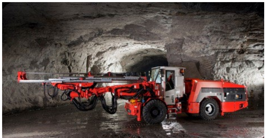
Kuva 1: Tyypillinen maanalainen tunnelinporauslaite varustettuna porauspuomilla.
