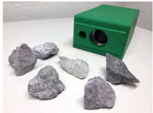
Kuvat 4 & 5. VTT:n kehittämä aktiivihyperspektrisensori ja malminäytteitä demonstraatiota varten
