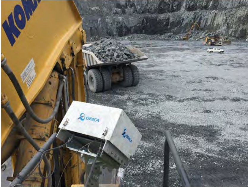
Kuva 1. Automaattinen fragmentaatiokamera asennettuna Komatsu 8000 lastauskoneen ylätasolle
