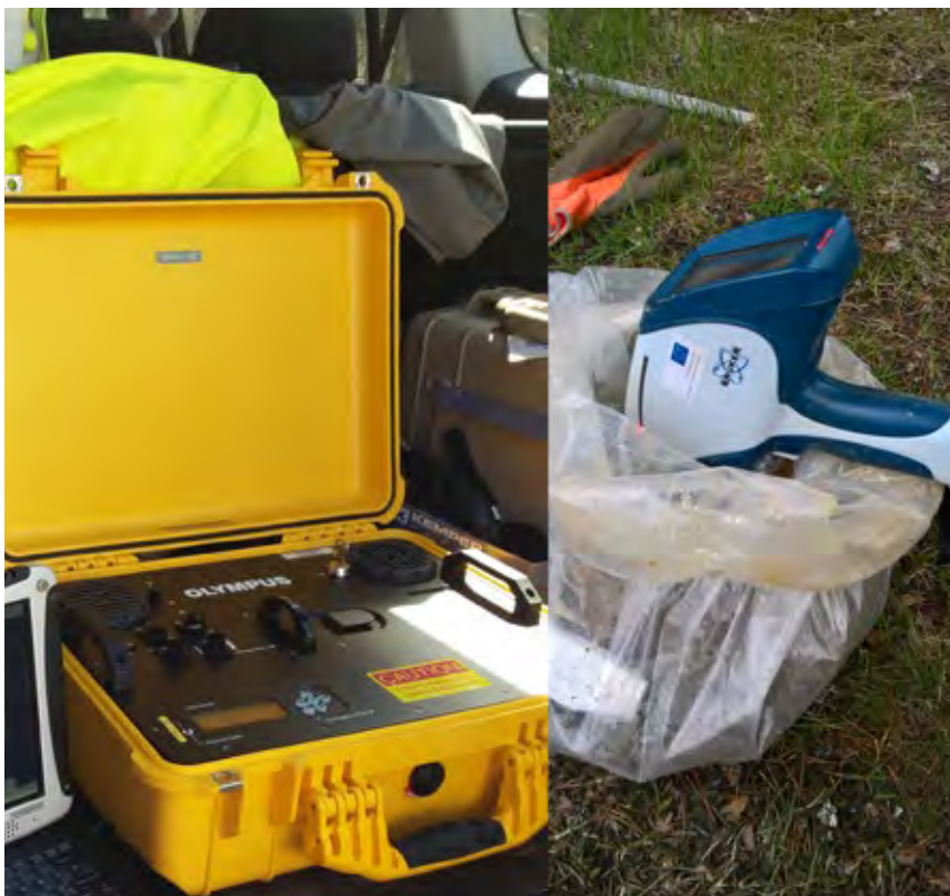
Kuva 2: GTK:n Olympus Terra Portable XRD-analysointilaitteisto (vas.) sekä Lapin AMK:n Bruker S1 Titan XRF-analysointilaitteisto.
