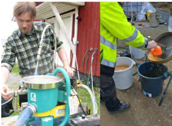
Kuva 3. Kenttärikastuskokeet tehtiin GTK:n kultakoiralla (vas.) ja Lapin AMK:n Knelson-separaattorilla (oik.).
