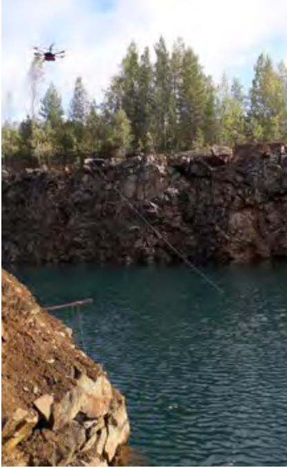
Sähköjohtavuusanturi matkalla 100 metrin syvyyteen Kotalahden Kuilulla.
