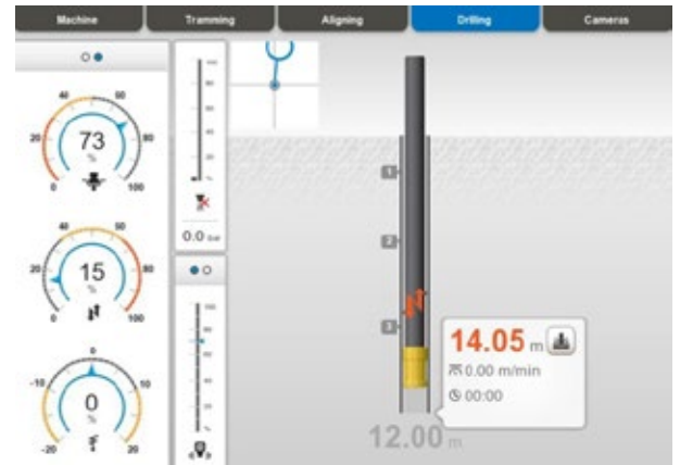
Kuva 2. RockPulse -mittarit poralaitteen ohjausjärjestelmässä. Drill Bit response (ylin) osoittaa kruunu-kivi -kontaktin laatua, Tools Load (keskellä) osoittaa iskun paluuheijastuksien määrää, ja Feed Level (alin) kertoo, ovatko porauksen säädöt ali- vai ylisytöillä.
