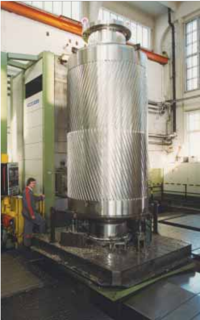
Kuva 6. Coiler drum, valmiiksikoneistettu, materiaali DRUMLOK 1000 Vaculok®, paino n. 23 000 kg, valajana Metso Lokomo Steels Oy.
