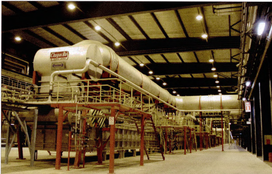
Integroitu valssaus-, hehkutus- ja peittänsilja edustaa alan uusinta teknologiaa. Yläkuvassa kylmävalssaamo, josta RAP-linja alkaa. Alakuvassa linjan hehkutusuuni.
