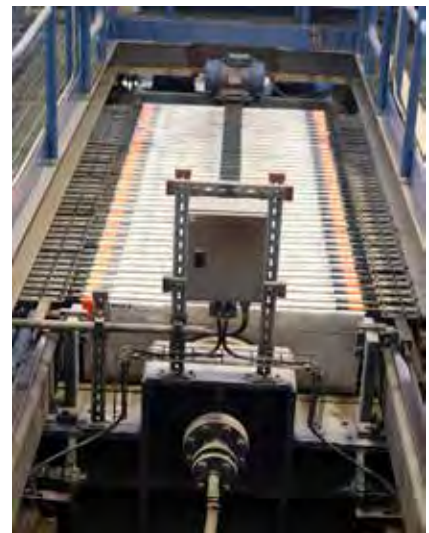
Kerrallaan kahden tonnin rikasterästä poistetaan vesi Metson painesuodattimella.
