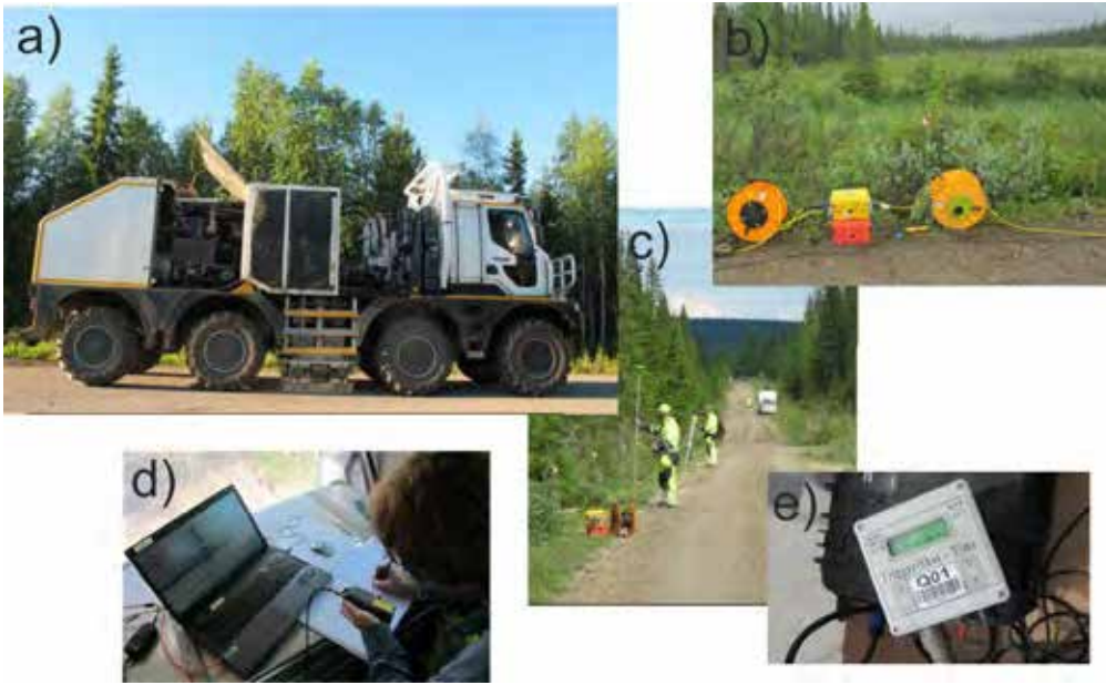
Kuva 2. XSoDEX-projektin heijastusseisminen luotaus tehtiin käyttäen tärytinrekkaa (a) tuottamaan seisminen lähdesignaali ja 360-kanavaista vastaanotinsysteemiä (b). Jokaisen yli 8000 vastaanotinpaikan koordinaatit mitattiin tarkkuus-GPS:llä (c) ja mittaussysteemi mahdollisti reaaliaikaisen aineiston laadun monitoroinnin (d). Projektin aikana mitattiin yli 10 000 yksittäistä lähdepistettä (e), joita on käytetty poikkileikkauksen muodostamiseen kallioperän rakenteista 8 km syvyyteen saakka.
