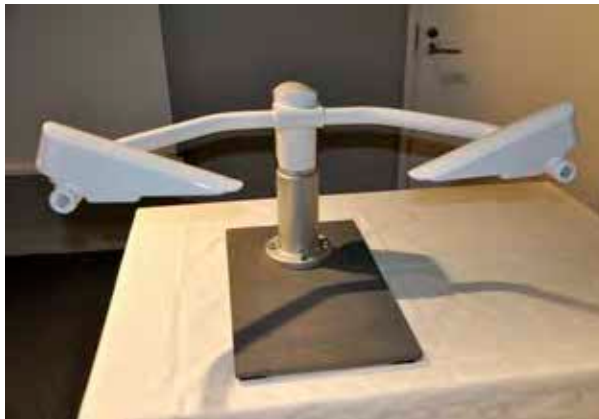
Vaisala Oyj:n optisen näkyvyys/vallitsevan sään mittausanturin mittauspää.
