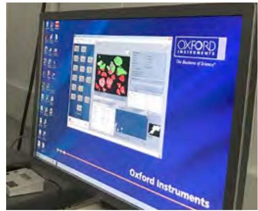
Kuva 4. FE-SEM-elektronimikroskooppilla voidaan tehdä kivi- ja sedimenttinäytteiden automatisoitu mineraalien tunnistaminen näytteen kvantitatiivisen mineraalijakauman selvittämiseksi.
