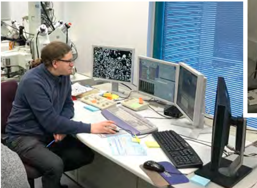
Kuva 3. Mikroanalyyttori (EPMA) on käytössä silloin, kun halutaan tehdä tarkka mineraaligeokemiallinen analyysi. Analyysiä tekemässä tohtorikoulutettava Marko Moilanen.
