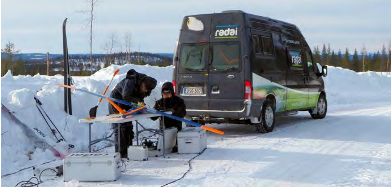
Timo Åman ja Jari Kesälahti alustavat lennokkia mittauslentoa varten napakassa 20 asteen aamupakkasessa Savukoskella talvella 2019. Nestekaasulla lämmitettävä matkailuauto toimii niin työmaakoppina kuin lennonvalvonta-asemanakin.
