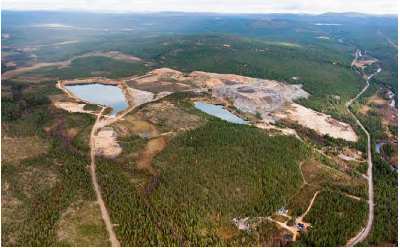
Kuva 3. Hannukaisen alueella on ollut aiempaa kaivostoimintaa, jonka jäljiltä alueella on kaksi vanhaa avolouhusta ja sivukiven sekä pintamaiden läjitysalueet.
