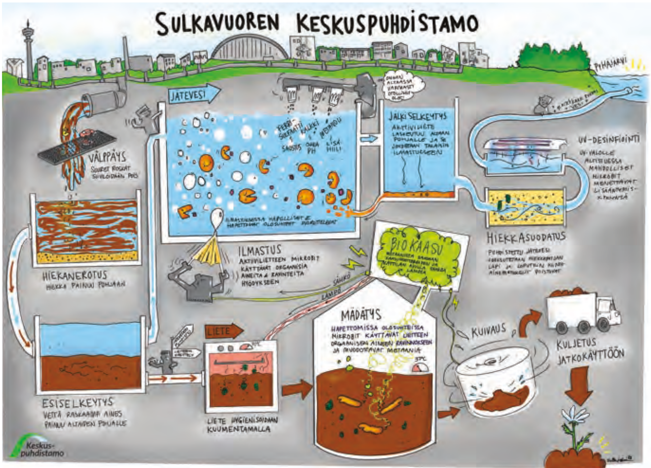
Kuva 2. Havainnollinen kuva tulevan keskuspuhdistamon prosessivaiheista
