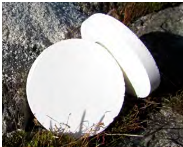
a) Kuva 2. Sekundääri-aineena käytetty rikastushiekka ja siitä valmistettu korkean jalostusarvon materiaali. a) Kaivosprosessin sivuvirta, rikastushiekka. b) Keraaminäytteet, joissa on käytetty kuvan a) rikastushiekkaa raaka-aineena.
