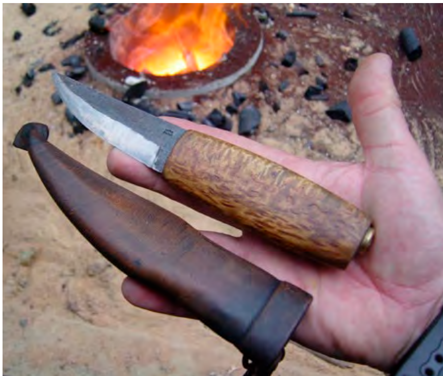
Jouni Jäppisen valmistama käyttöpuukko Ahvenkosken malmista sulatetusta teräksestä.
