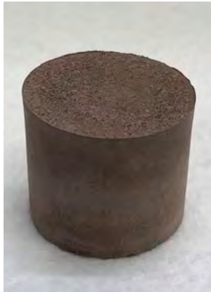
Kuva 3. Rikastushiekoista valmistettu geopolymeeri.
