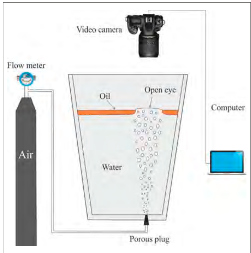
Kuva 1. Havainnollistus 1:5-mittakaavan vesimallista.[7]
