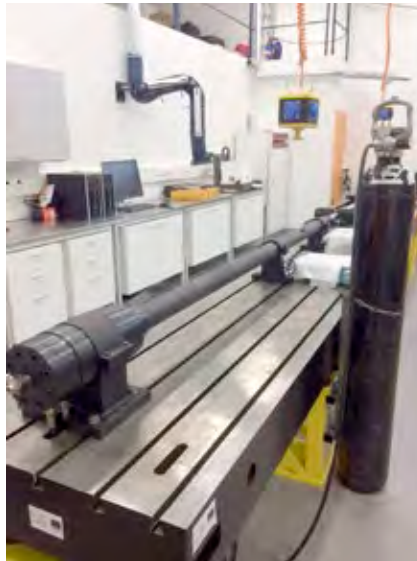
Split Hopkinson Pressure Bar (SHPB) dynaamisen uniakiaalisen puristuslujuuden mittaamiseen.
