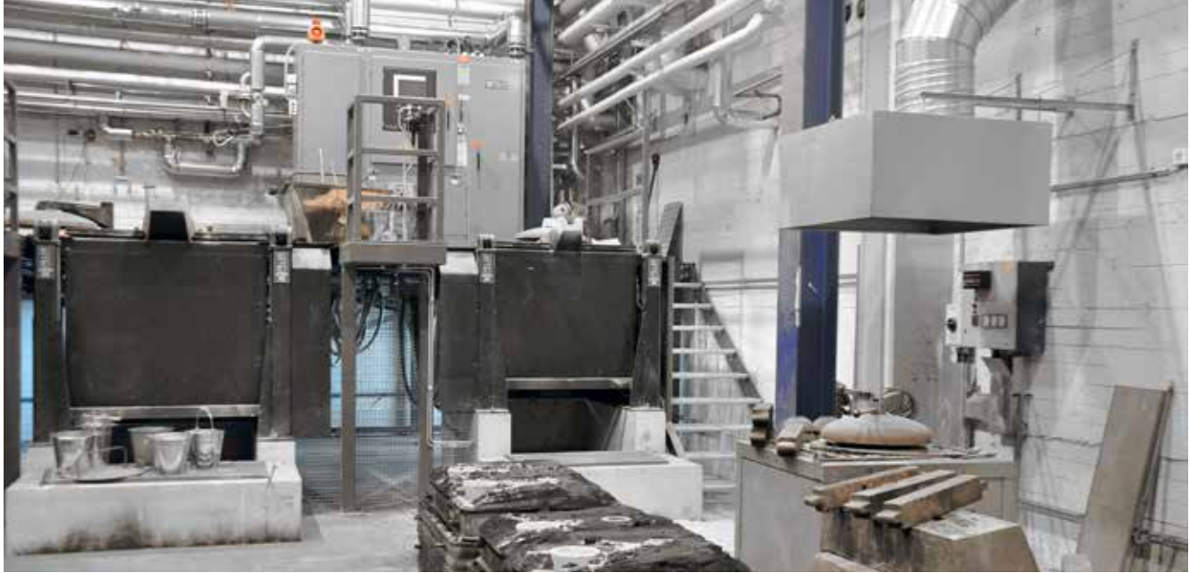
Oppimisympäristön uudet sulatusuunit kapasiteetiltaan 500 ja 750 kg
