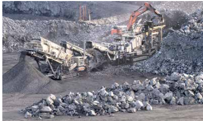
Sepeliasema Kevitsan kaivoksella Sodankylässä, missä sivukivestä murskataan sepeliä kaivoksen käyttöön.
