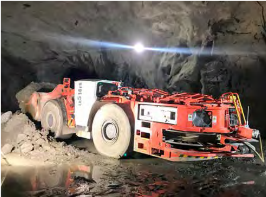
Kuva 2: Sähköinen 14 tonnin lastari teknologiademonstraattori Sandvikin testikaivoksessa
