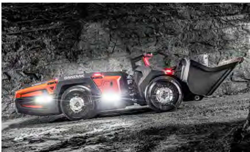
Kuva 3: Seitsemän tonnin lastari, kaivosautomaation hytityn sähköistetty teknologiademonstraattori Sandvikin testikaivoksessa
