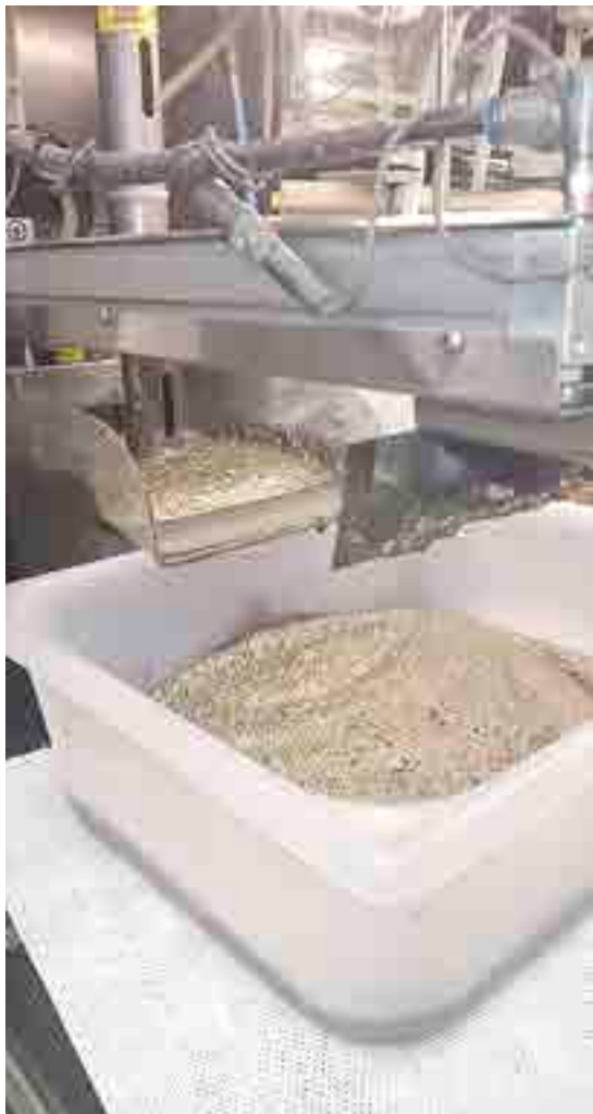
Laboratoriovaahdotuskokeilla saadaan dataa prosessin metallurgista massabalanssia ja simulointia varten.
