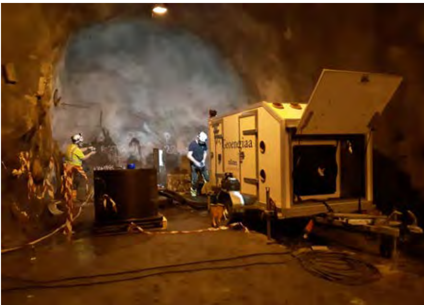
Kuva 3. GTK:n tutkijaryhmä valmistelemassa Pyhäsälmen kaivoksen maanalaisen lämmön testipumppausta
