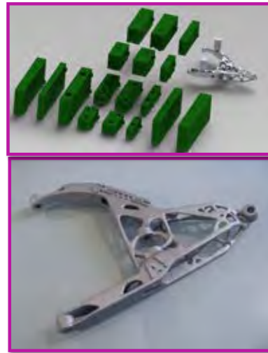
Kuva 5. Autossa käytettävä A-tukivarsi (alakuva) ja sen valamiseen käytetyn 3D-tulostetun muotin osat (yläkuva)
