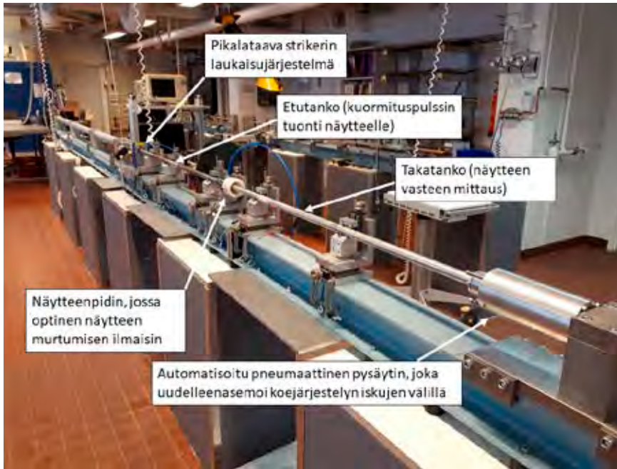
Kuva 2. Tampereen yliopiston Materiaaliteknikan yksikössä kehitetty syklinen Split Hopkinson Bar-laitteisto.
