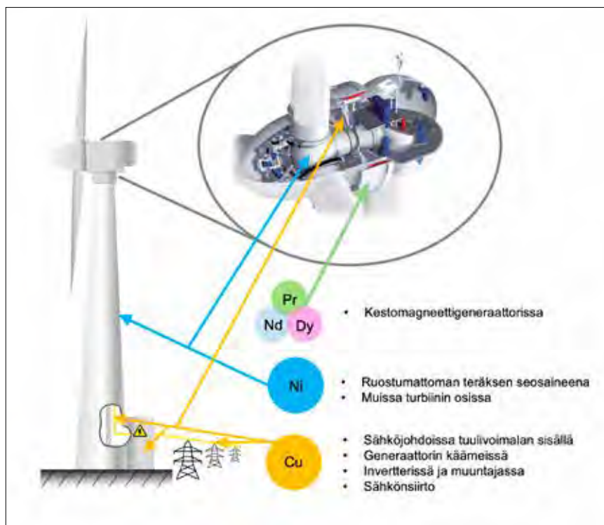
Kuva 5. Metallien käyttökohteita tarkemmin tuulivoimalassa. Nasellin poikkileikkauskuvaa [19]
