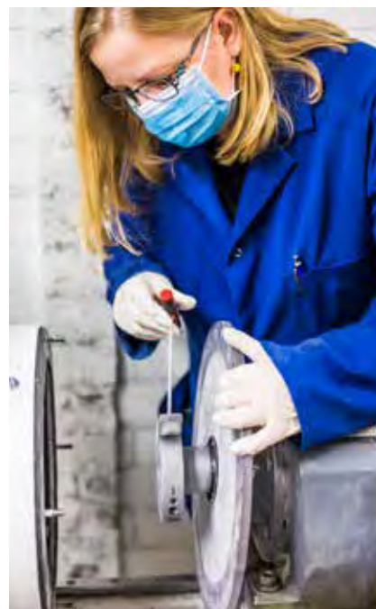
Kati Valtonen kiinnittämässä näytettä impeller-tumbler testilaitteistoon
