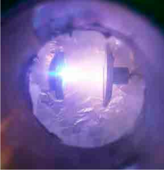
Kuva 2: Laserin osuessa alumiinioksidista valmistettuun kohtioon (vasemmalla), pinta-aine hajoaa plasmaksi, joka laajetessaan vakuumiin jäähtyy nopeasti ja muodostaa alustalle (oikealla) amorfista alumiinioksidia.
