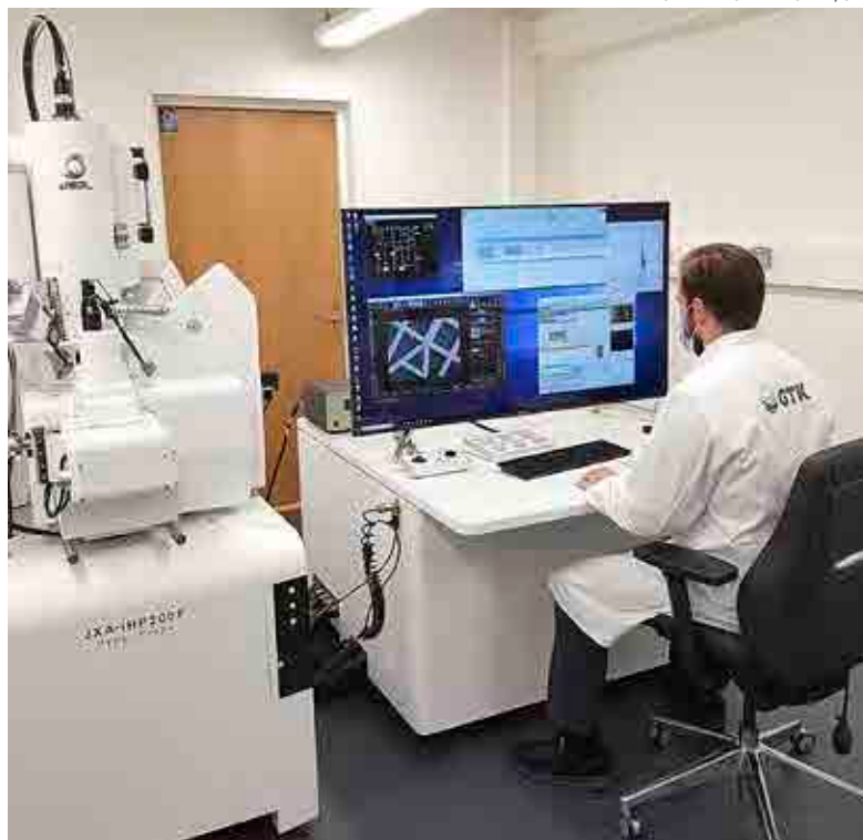
Radoslaw Michallik käyttää GTK:n tutkimuslaboratorion uutta mikroanalysaattoria JEOL JXA-iHP200F Circular Raw Materials Hubissa.
