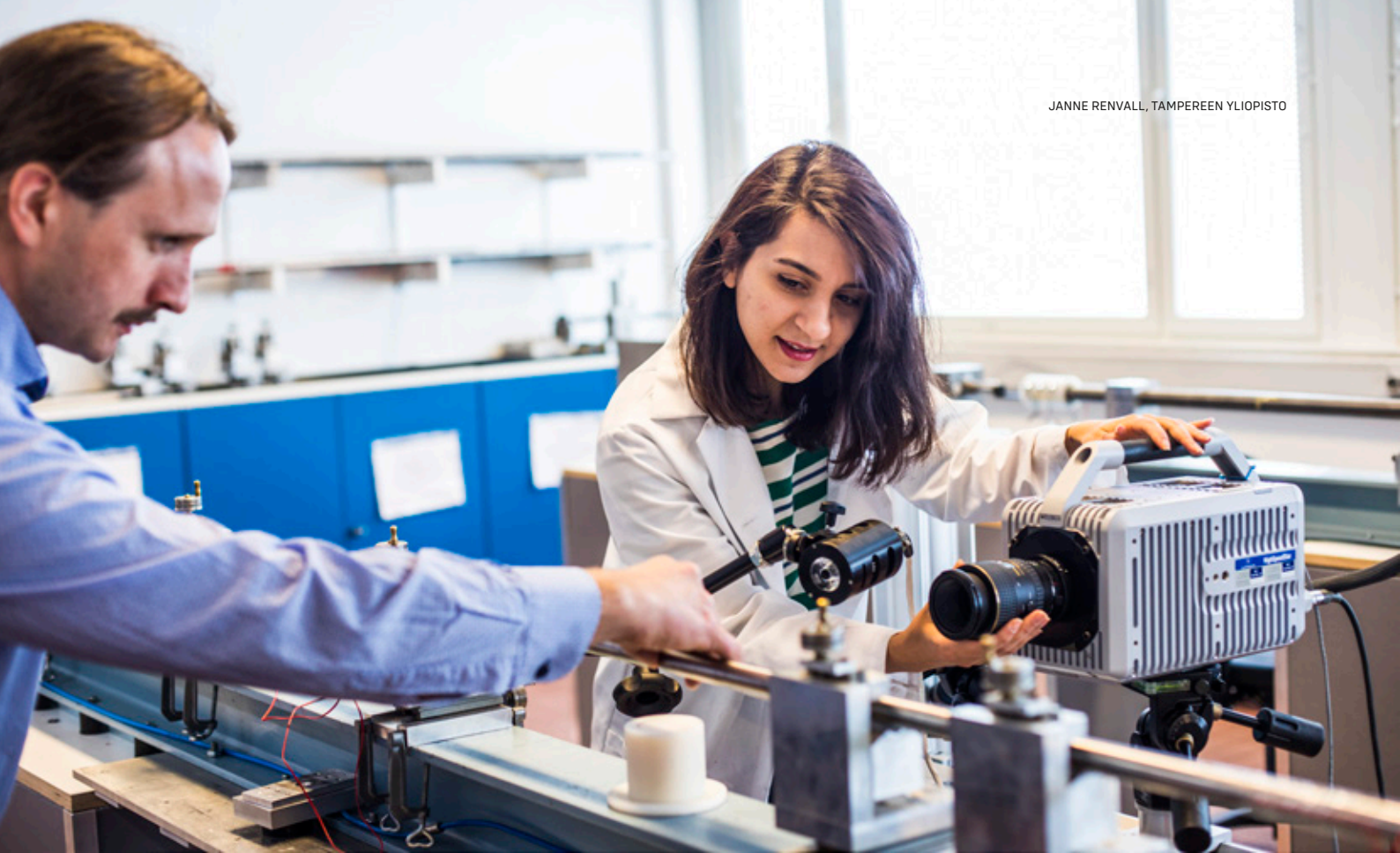
Kuva 1: Professori Mikko Hokka ja tohtorikoulutettava Nazanin Pournoori kohdistamassa suurnopeuskameraa Hopkinson Split Pressure Bar -koetta varten
