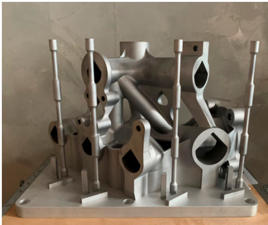
Alumiinista 3D-tulostettu, vielä valmistusalustassaan kiinni oleva, yli puolimetrisen hydraulilohko samassa ajossa valmistettujen testikappaleiden kanssa
