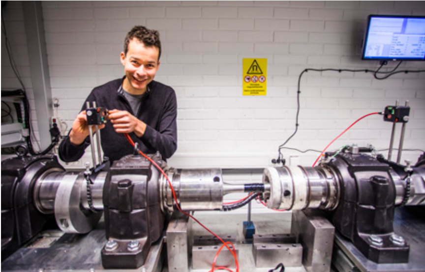
Kuva 1. Tkt Matti Isakov suuren mittakaavan kiertoväsymyskoneen parissa
