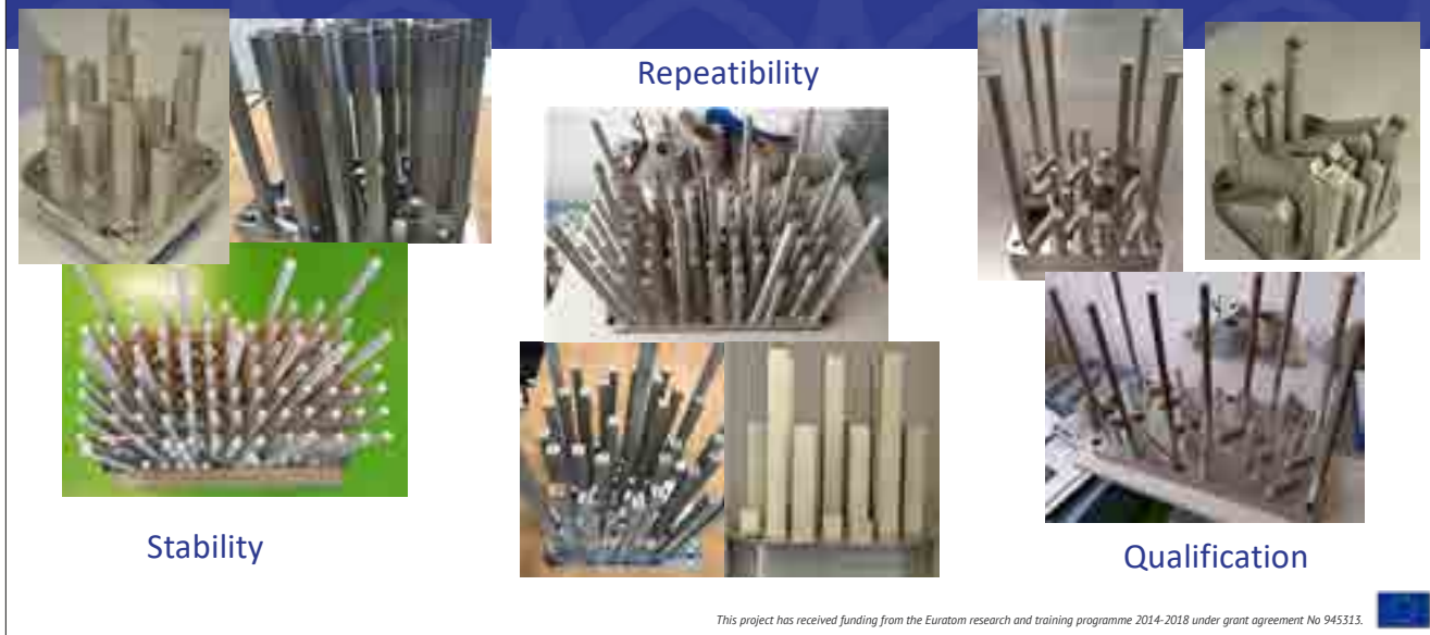
Kuva 2. 3D-tulostettuja koesauvoja eri materiaali- ja prosessiominaisuuksien testaamista varten.
