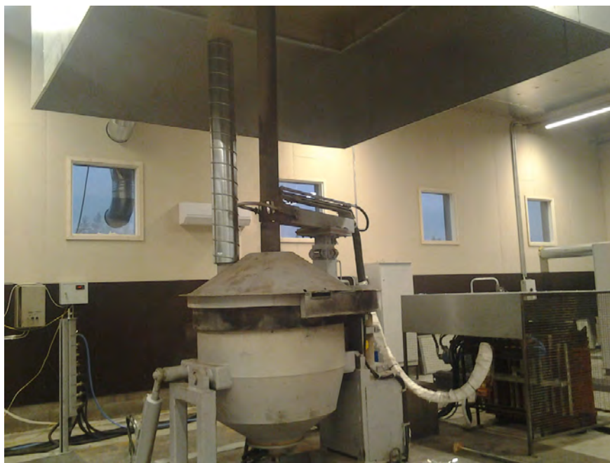
Karhulassa käytetty Maseratan 500 kg:n DC EAF – tasavirtavalokaariuuni
