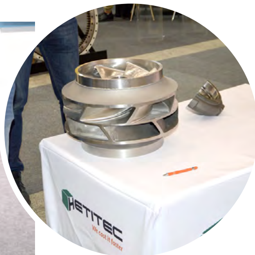
Kuva 4. 3D-tulostettua hiekkamuottia käyttäen valettu pumpun juoksupyörä. Materiaali duplex-teräs (Hetitec)
