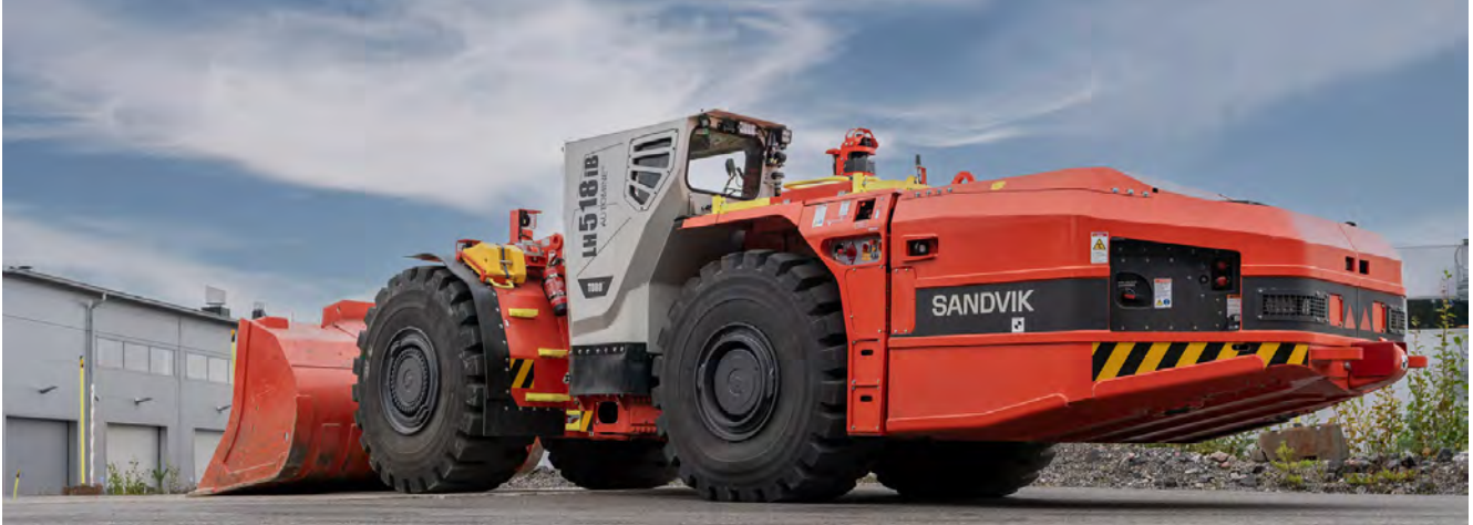
Sandvikin akkukäyttöinen Toro™ LH518iB on automaatiovalmis lastauskone 18 tonnin hyötykuormalla.
