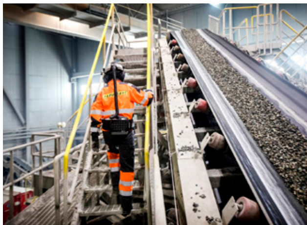
Tapojärvi on käsitellyt rikastamoissaan terästehtaiden kuonia jo vuosikymmenien ajan. Kuva on Tapojärven Tornion jaloteräskuonan rikastamosta.
